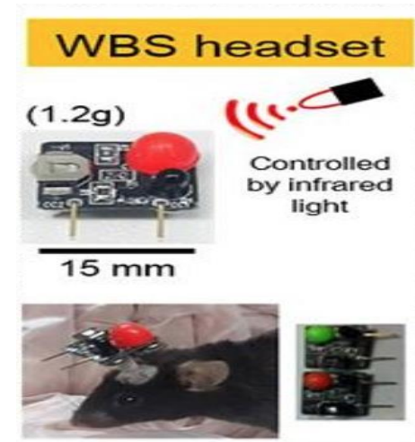
무선으로 적외선을 조사하여 생쥐의 내측전뇌다발(medial forebrain bundle)을 자극하도록 고안된 초소형 헤드셋
