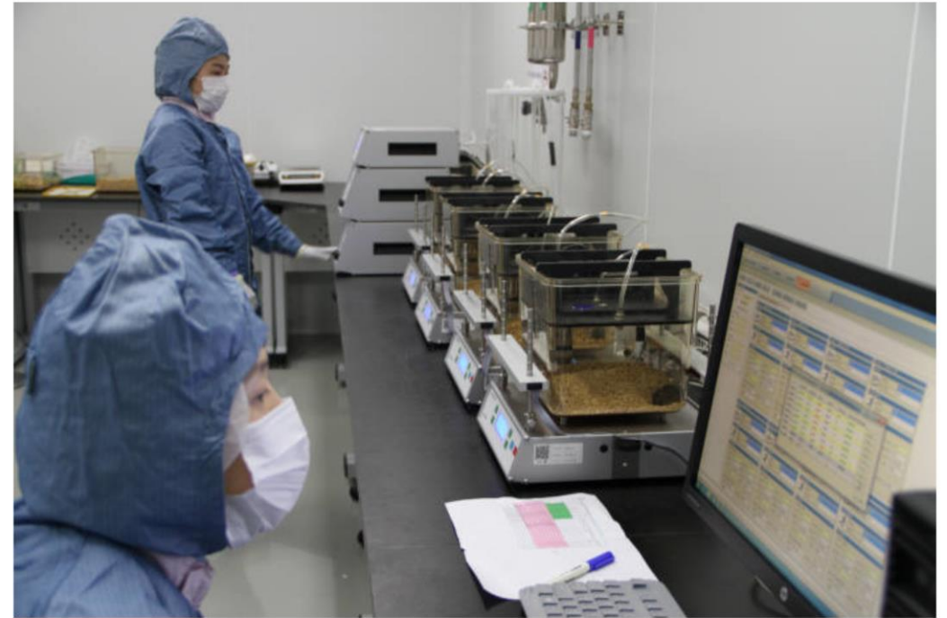
<연구원들이 행동분석구역에서 `대사량측정시스템`을 이용해 마우스의 산소 소모량을 측정하고 있는 모습>
