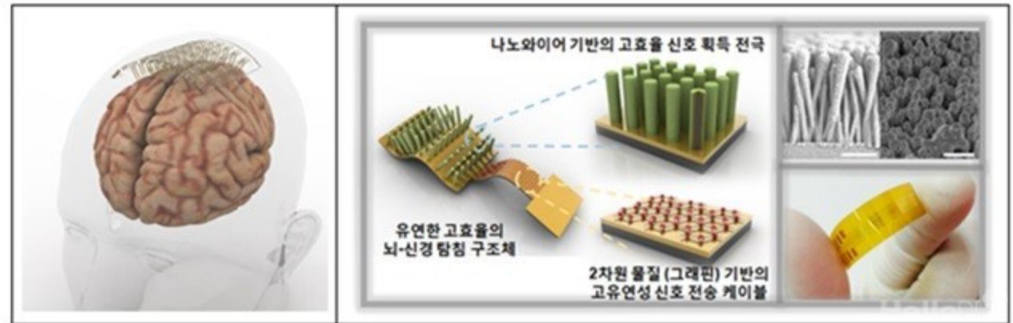
장재은 교수 연구팀이 개발한 고효율 뇌신경 탐침의 구조. 오른쪽 하단은 실제 제작된 탐침 모습.<사진=DGIST 제공>
