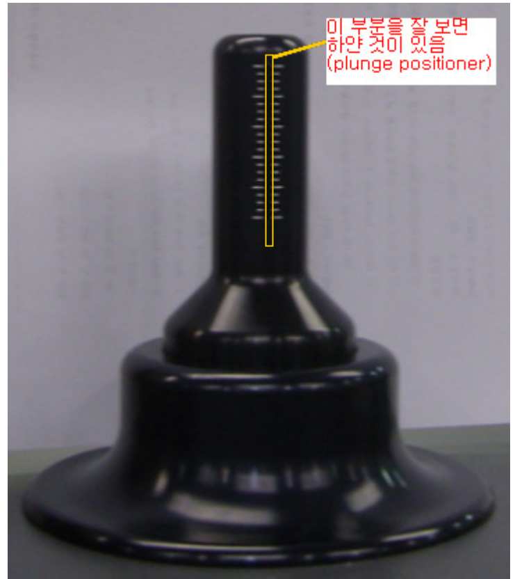
▲ 그림 10. Buret assembly 및 장착했을 때의 사진. 오른쪽 사진에 표시해 놓은 부분을 잘 보면, 사진에서는 보이지 않지만 하얀 positioner가 있다. 적정이 진행되며 이 positioner가 점점 아래로 내려온다.
