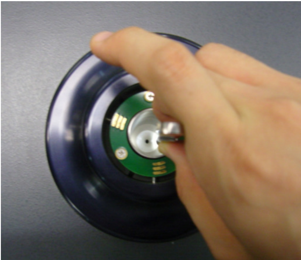
▲ 그림 23-1. Dummy needle 삽입
