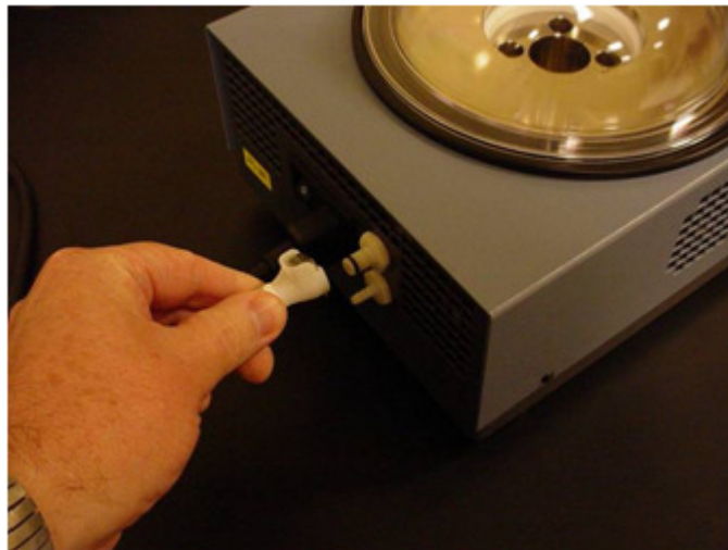
▶ 그림 28. Cleaning tool 의 장착(1)
